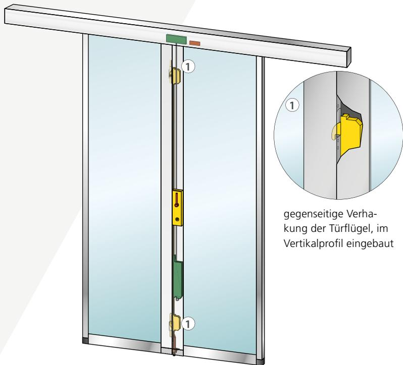
gegenseitige Verhakung der Türflügel, im Vertikalprofil eingebaut
